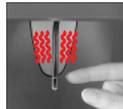
**6.4 Bei ausgeschalteter Dampftaste (21) jetzt den Drehknopf Dampf wieder öffnen – Anzeige Heisswasser / Ueber-temperatur – und das Gerät solange entlüften, bis aus der Düse ein ruhiger Wasserstrahl ausströmt und nur noch die Anzeige Heisswasser erscheint (ohne Übertemperatur).**
