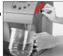
**10.7 Um die Anzeige Entkalken zu löschen, gehen Sie jetzt in den Programmiermodus**, (Taste «ent» gedrückt halten bis Anzeige **Sprache** erscheint gemäss Punkt 8.0). **Mit den Pfeiltasten ^ und v** jetzt den Programmpunkt «Kalkanzeige» **anwählen und aktivieren mit Taste «ent»** es erscheint:
