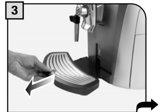
3 Die Abtropfschale herausnehmen, entleeren und reinigen.
