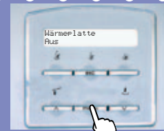
Menü-Taste zur Bestätigung der Auswahl drücken.
