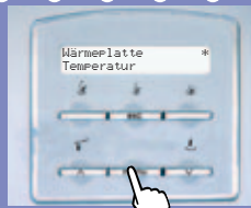
Wenn die Funktion erscheint, mit der Menü-Taste auswählen.
