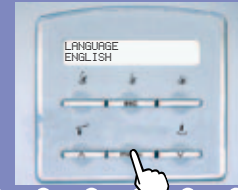
Menü-Taste zur Bestätigung der Auswahl drücken.
