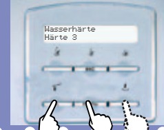
Entsprechenden Härtegrad auswählen (z.B. 2 Quadrate = Härte 2) und mit der Menü-Taste speichern.
