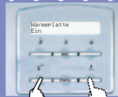
Wärmeplatte ein- oder ausschalten.
