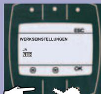
Anwählen, ob die Programmierungen der Maschine wieder auf die Werkseinstellungen zurückgesetzt werden sollen.
