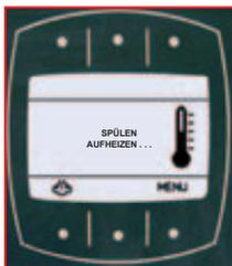
Die Maschine ist in der Aufheizphase; abwarten, bis die Maschine diesen Vorgang abgeschlossen hat.
