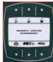
Den Filter "Aqua Prima" so bald wie möglich auswechseln; falls kein neuer Filter zur Hand ist, den vorhandenen herausnehmen und die Funktion "Wasserfilter" ausschalten (siehe Programmierung).
