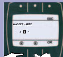
Entsprechenden Härtegrad anwählen (z.B. 2 Quadrate = Härte 2) und mit der OK-Taste speichern.
