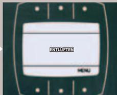
Das Display zeigt an, dass die Leitungen der Maschine befüllt werden müssen.
