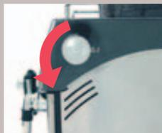
Dampfdrehknopf zum Starten des Kreislauf-Auffüllvorgangs öffnen.
