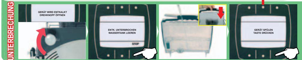
Der Drehknopf kann zum Unterbrechen des Entkalkungsvorgangs geschlossen werden.
