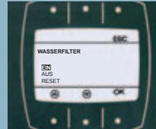
Siehe "Programmierung". Die Filterkontrolle einschalten und die Wasserzählung zurücksetzen.
