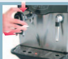
Auslauf abmontieren und mit Wasser waschen.
